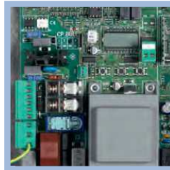
Motorsturing met geavanceerde programmering via display. Met ingebouwde ontvanger
