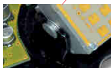
Radar module horizontaal en verticaal verstelbaar
