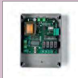
Ontvanger 4-kanaals 433,92 Mhz Programmeerbaar via display RR.4WBV: 230V voeding RR.4WBV24: 24V voeding
