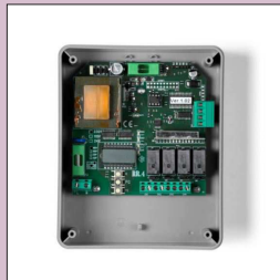
Ontvanger 4-kanaals 433,92 Mhz met programmeerbare codes Programmeerbaar via display RR.4WBP voeding 230Vac RR.4wbp24 voeding 24Vac/dc Max. 4 relaisuitgangen tot 5A
