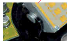
Radar module horizontaal en verticaal verstelbaar
