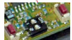
Basis instellingen door middel van push buttons op de sensor
